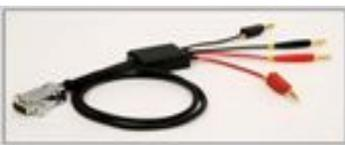
选件 143-60 电缆适配器是为模拟 RTD 温度传感器而设计的, 该适配器连接到前面板 AUX 端子; 铂、镍传感器的温度依赖于校正器内预先的定义。
